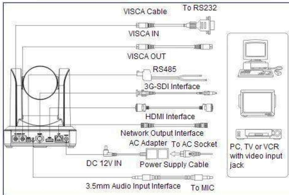
Рисунок 2.3. Схема внешнего интерфейса модели ST.
