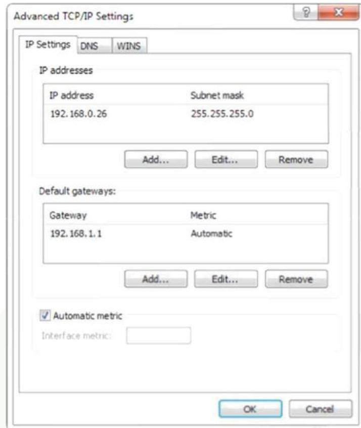
**Примечание:** Добавляемый IP адрес должен отличаться от других адресов компьютеров или устройств. Перед добавлением необходимо проверить наличие этого IP адреса.
