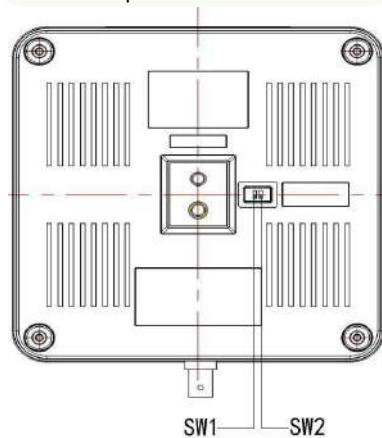
Рисунок 2.6 Схема нижних DIP переключателей
