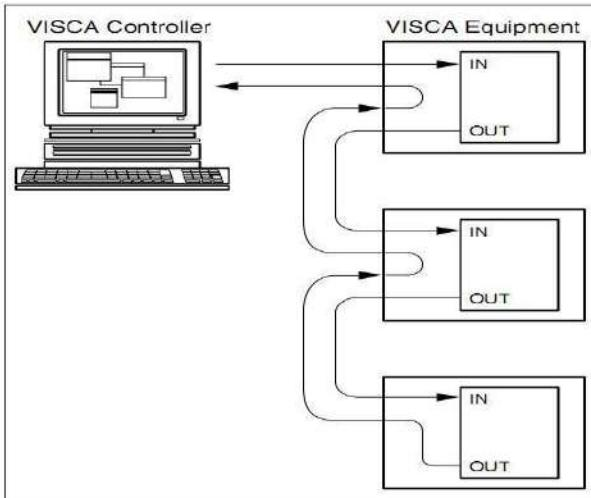
Метод последовательного подключения камеры
