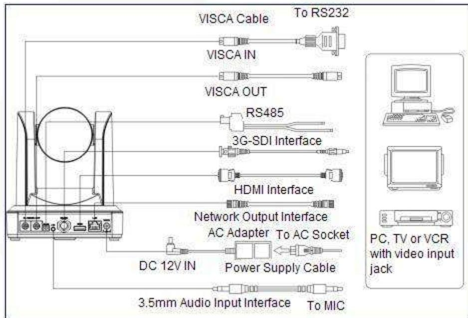
Рисунок 2.3. Схема внешнего интерфейса модели ST.
