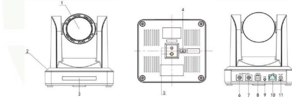
Рисунок 1.2 Интерфейс модели серии 1011U (USB3.0)
