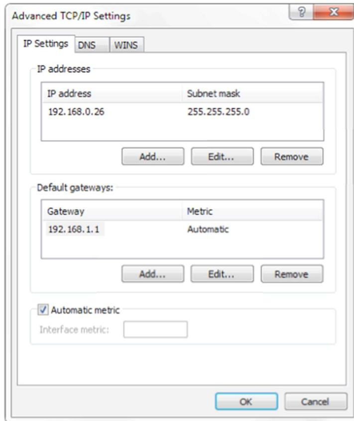
**Примечание:** Добавляемый IP-адрес не может совпадать с IP-адресом других компьютеров или устройств. Существование этого IP-адреса необходимо проверить перед добавлением.
