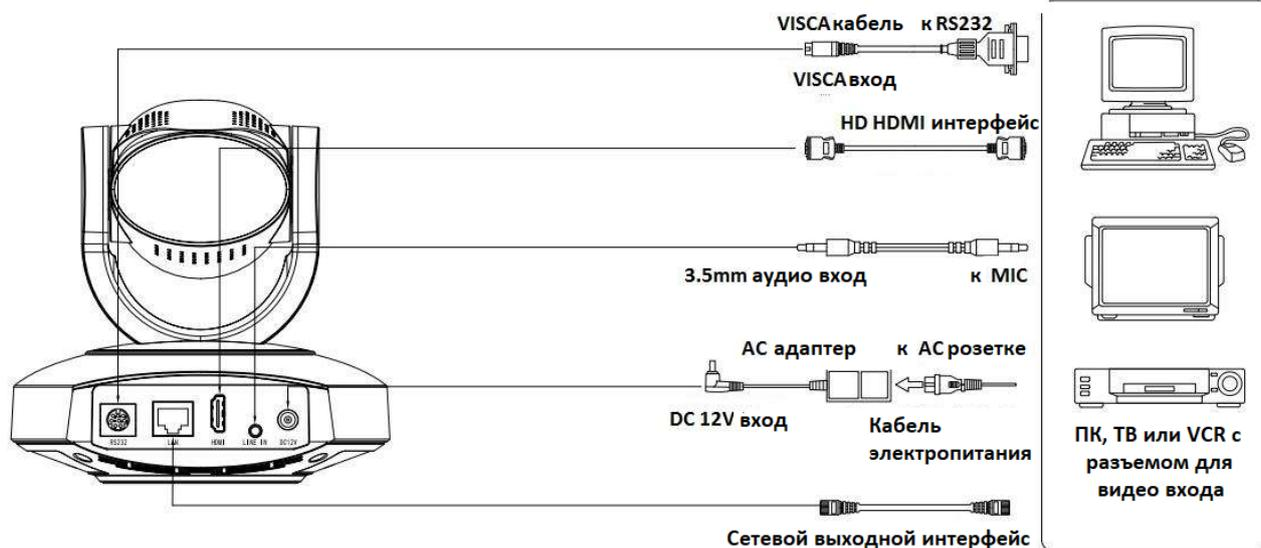
Рис. 2.4 Схема внешнего интерфейса модели HDMI
