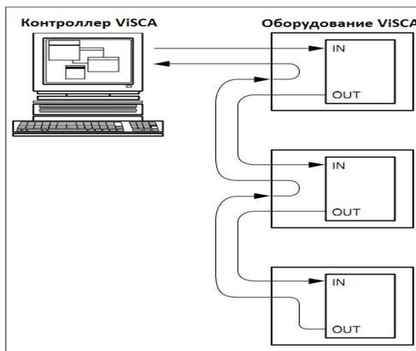
Метод каскадного подключения камер
