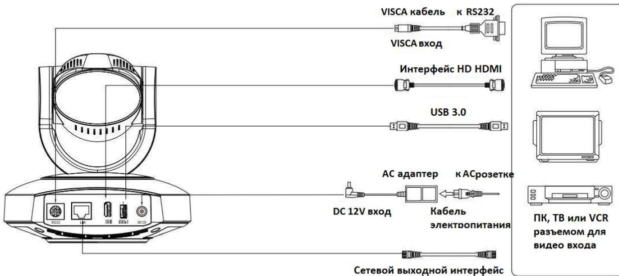
Рис.2.5 Схема внешнего интерфейса модели USB3.0 + HDMI
