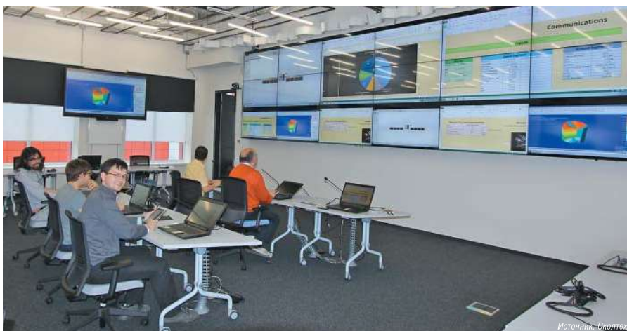
Рис. 1. Основным средством отображения информации в мультимедийной лаборатории CEDF Сколтеха является видеостена формата 6×3, построенная из ЖК-экранов, поддерживающих режим 3D-отображения контента. При разделении зала акустической шторой на два изолированных помещения видеостена автоматически делится на два экрана 3×3
