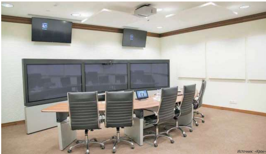
Рис. 8. Комната телеприсутствия в составе программно-аппаратного комплекса мультимедийных систем ЕЭК
